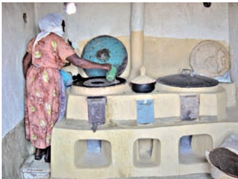
Die Bauweise des energiesparenden Kochherds erlaubt eine ungehinderte Luftzirkulation. Die gewölbten, hohlen Keramiksteine sind mit einer Isolierschicht aus Asche oder Sand gefüllt, so dass möglichst wenig Hitze an die Umgebung abgegeben wird. © LWB/AWD-Eritrea/A. Fisseba
